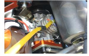
Il carburatore è un Tillotson a membrana con aspirazione lamellare
