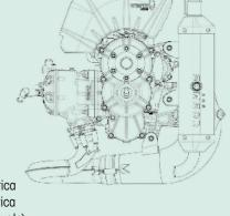
timo motore. Potente, con grande coppia ai medi regimi (quelli che si usano di più in volo) ed estremamente regolare nel funzionamento. A breve lo proveremo su un Minifox, senza dubbio un'installazione più centrata. Difetti? In questa prima presa di contatto nessuno, ma se proprio se ne deve trovare uno è il peso che in questa versione (doppio avviamento e doppia accensione) sale a 27 kg a secco (radiatore incluso, liquidi esclusi).
